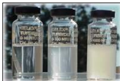
Slika 1.3 Standardni uzorci različite mutnoće (5, 50 i 500 NTU-a)
