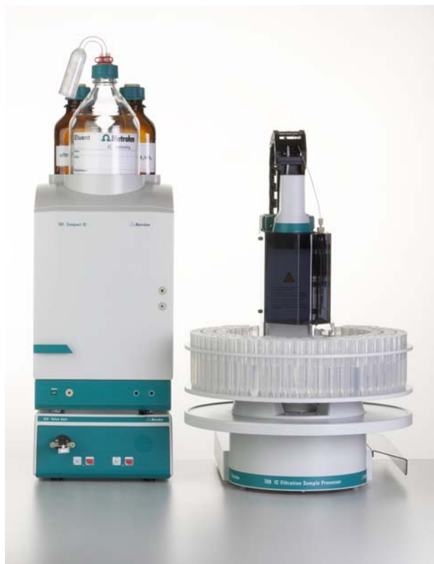
Slika 7.2 Prikaz jonskog hromatografa za određivanje jona u vodi
