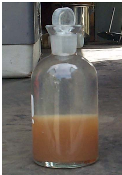
Slika 9.2 Vinklerova boca za određivanje kiseonika
