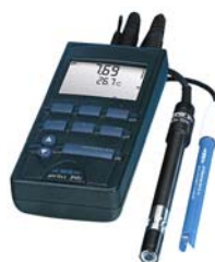
Slika 2.1 Konduktometar (Instrument za određivanje provodljivosti)
